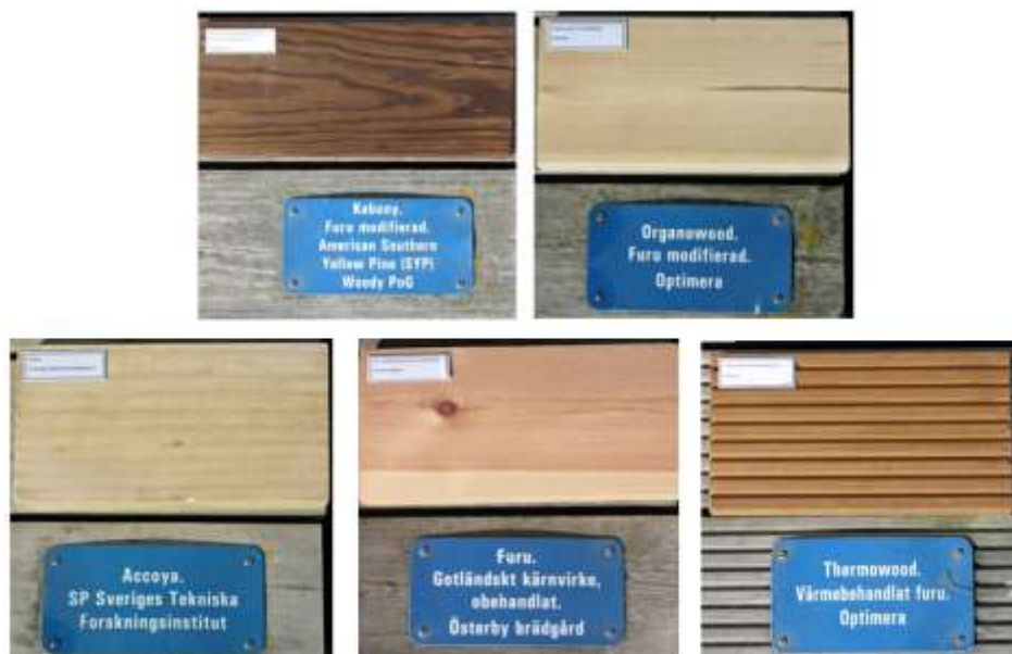
Figur 13. Foto som visar hur färgen förändrats kraftigt hos de modifierade trämaterialen sedan den inledande besiktningen och den senaste inspektionen. Även furukärna från Gotland finns med. Den bilden visar tydligt att plankan inte består av 100 % kärnvirke (rosafärgade övre delen) utan även splintved (ljus parti).
