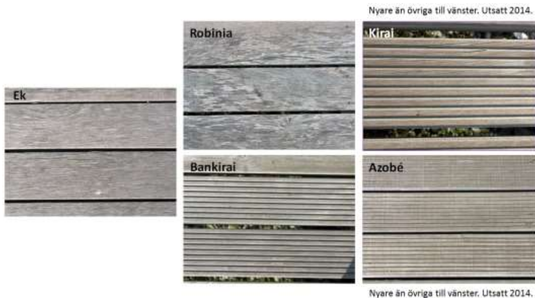
Figur 14. Utseende hos de naturligt beständiga lövträslagen i brygga K vid det senaste inspektionstillfället.
